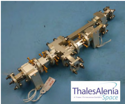
Figura 3. Triplexor del transpondedor de banda Ka de la sonda Mercury Planetary Orbiter (MPO) de la ESA que forma parte de la misión BepiColombo diseñado por UPM-UAM.
